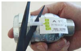
Bild 1: Verschraubung der Baureihe 150 nehmen und Sicherungsband durchtrennen.
